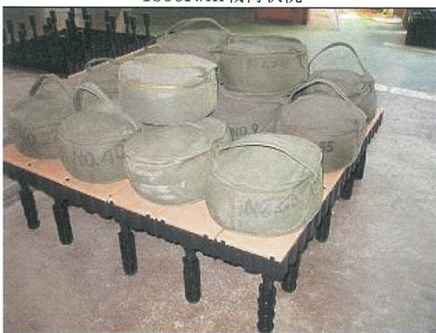
写真 5 LL支持脚+台座 3個 樹脂タイル 1800N/m 2 載荷状況
