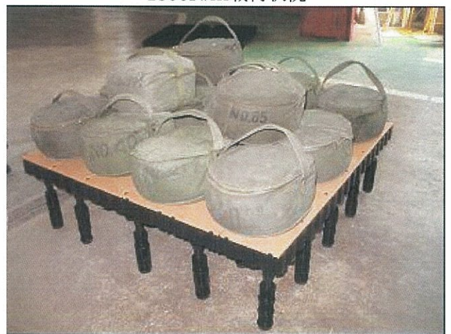
写真 4 LL支持脚+台座 3個 磁気タイル 1800N/m 2 載荷状況
