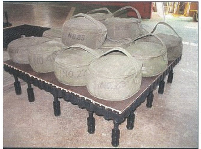
写真 2 LL支持脚+台座 2個 木粉入りデッキ材 1800N/m 2 載荷状況
