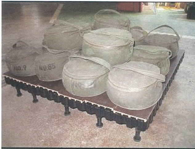
写真 1 LL支持脚 木粉入りデッキ材 1800N/m 2 載荷状況
