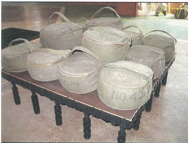
写真 3 LL支持脚+台座 3個 木粉入りデッキ材 1800N/m 2 載荷状況
